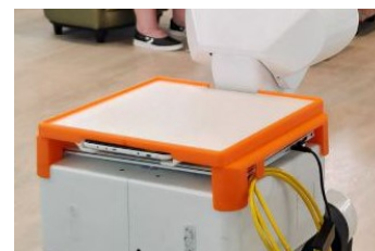
Figura 2: Vista de la parte trasera de la bandeja de TIAGo. Se aprecia la tablet alojada en su compartimiento correspondiente.
