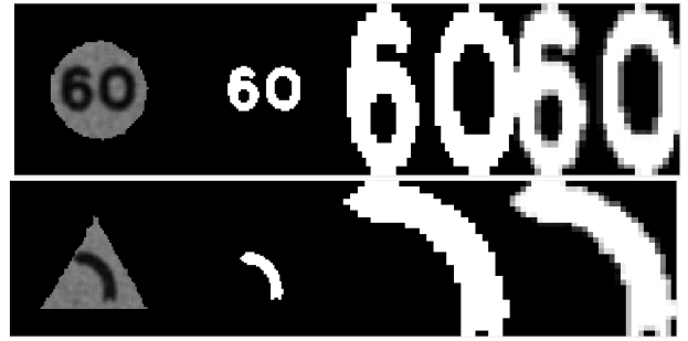
Figura 15: Ejemplos de extracción de las serigrafías de la imagen original, conversión a BW, centrado y normalización de las serigrafías.
