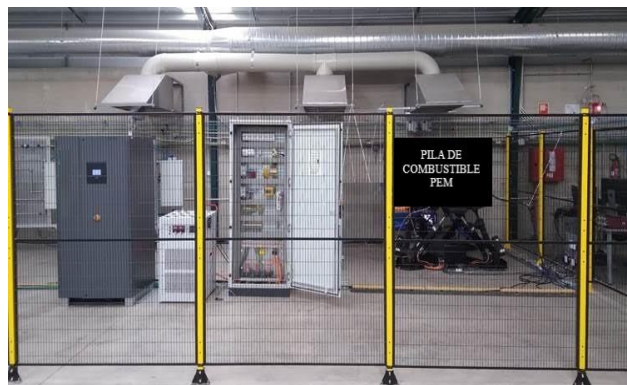
Figura 2: Banco de ensayos de una pila de combustible PEM en el CNH2.
