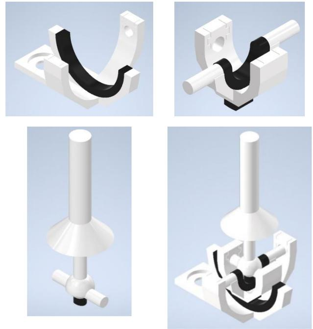
Figura 2: Diseño de los distintos elementos del sistema sensor. (a) Base inferior fija, (b) Elemento intermedio que rotará según el valor de la coordenada independiente ' $\phi$ ' sobre la base fija, (c) Palanca que rotará según el valor de la coordenada independiente ' $\theta$ ' sobre el elemento intermedio y (d) Conjunto ensamblado.
