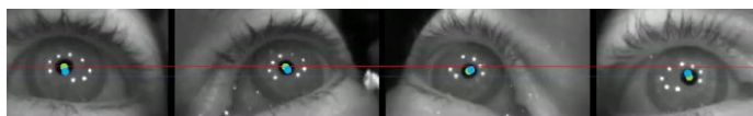
Figura 4. Diferencia de alturas entre pupilas debido a una incorrecta colocación de las gafas (líneas horizontales roja y azul) y corrección teórica del centro de las pupilas (azul claro)
