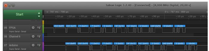
Figura 7: Comparación entre las formas de onda correspondiente al paquete generado por la versión basada en Arduino y la versión basada en la plataforma FPGA.
