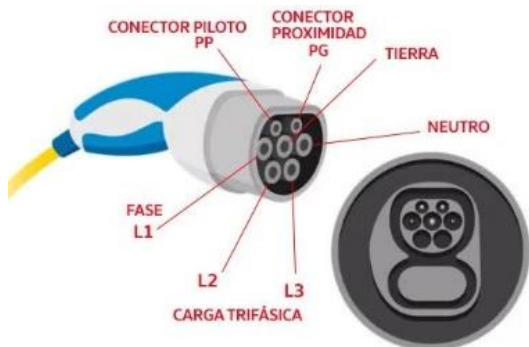
Figura 8: Esquema del conector Mennekes.
