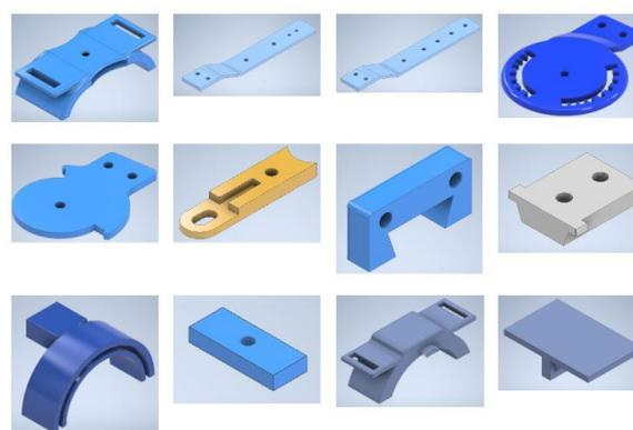
Figura 4: Despiece de la órtesis inteligente.
