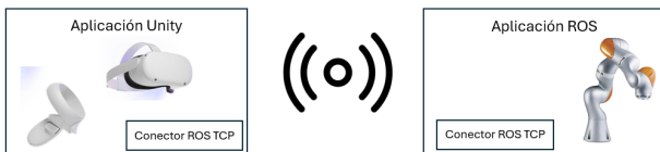
Figura 7: Comunicación del sistema vía ROS mediante el conector ROS-TCP, que permite la comunicación entre Unity y el nodo del robot implementado en ROS.
