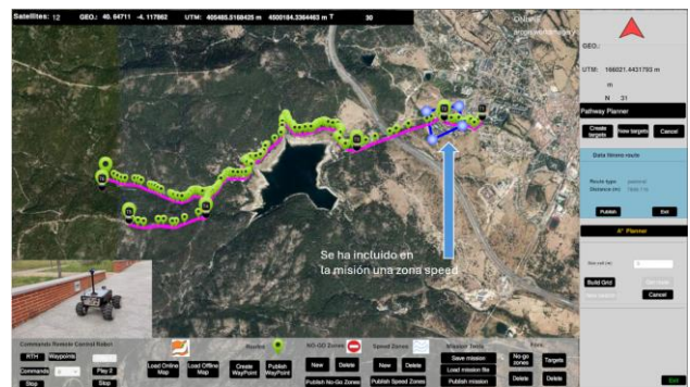
Figura 6: Ruta óptima propuesta por el buscador con zona speed . La ruta esquiva el pantano. Abajo a la izquierda una imagen del robot siguiendo la ruta.
