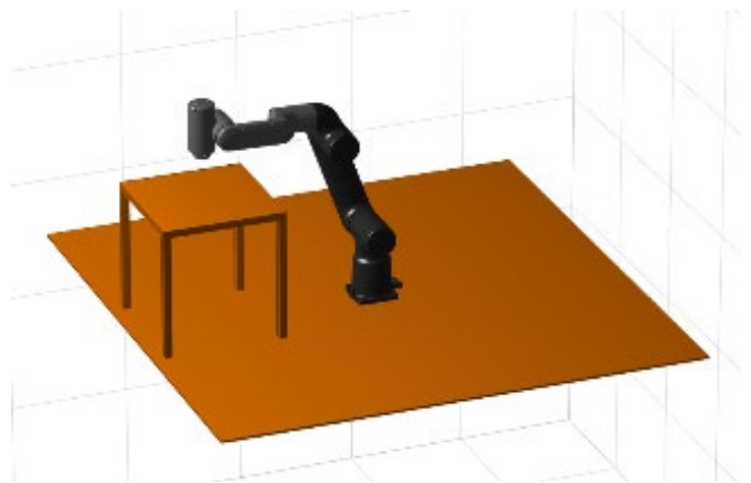
Figura 1: Representación del entorno de simulación: obstáculos y robot CRB15000.
