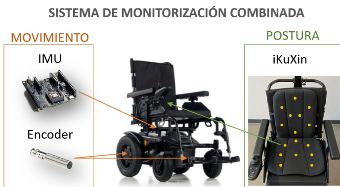
Figura 1: Sistema de monitorización compuesto por dos módulos: dispositivo de monitorización postural (en verde) y el del movimiento de la silla (en naranja).
