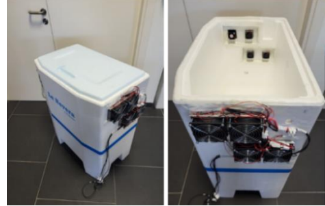
Figura 2: Vistas del recipiente y el sistema de refrigeración. El sistema de refrigeración se compone de cuatro módulos Peltier, estando situados dos de ellos a cada lado del recipiente.
