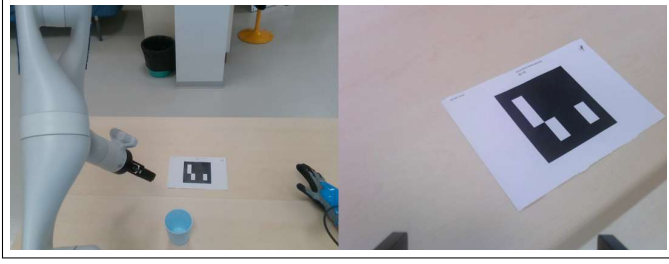
Figura 3: Marcador ArUco visto desde la cámara externa (izquierda). Marcador ArUco visto desde la cámara del brazo (derecha).
