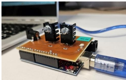
Figura 1. Imagen de la placa de control de temperatura encajada en Arduino UNO.
