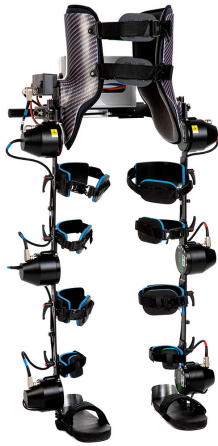
Figura 1: Exoesqueleto Robótico Exo-H3 desarrollado por Technaid.
