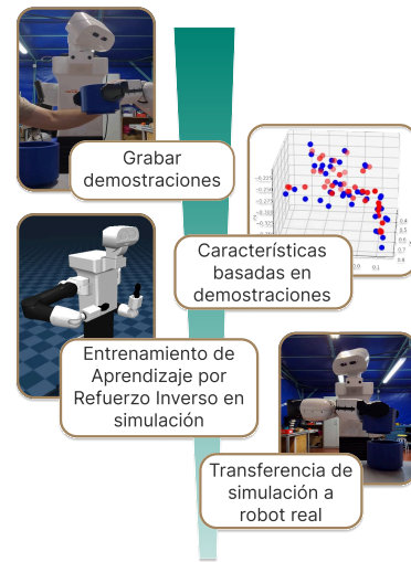
Figura 1: Esquema de la implementación de EXBAL-IRL con el robot TIAGo++. Primero, se graban las demostraciones del experto, luego se definen las características a partir de ellas y se entrena el modelo en simulación. Finalmente, el modelo se transfiere al robot real.
