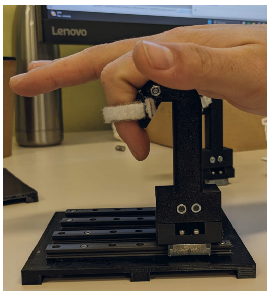
Figura 4: Mecanismo de sujeción del dedo con cinta de velcro y articulación pasiva
