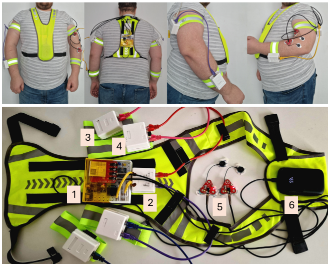
Figura 2: Módulo del paciente: (arriba) Vista general; (abajo) Colocación de los componentes del sistema: 1 - módulo CPU, 2 - RJ45 caja de comunicación, 3 - IMU de antebrazo, 4 - IMU de bíceps, 5 - MYOWARE 2.0 Muscle sensor, 6 - Bolsillo con batería
