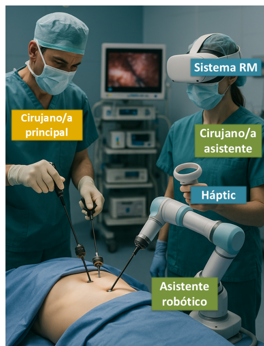
Figura 1: Consola de teleoperación de Realidad Mixta (RM) para un asistente robótico quirúrgico formado por unas gafas de realidad virtual (RV) en las que se muestra la imagen real del endoscopio junto con información aumentada del sistema, y un controlador háptico para el manejo de la herramienta (imagen generada con IA).
