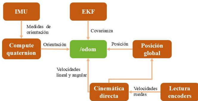
Figura 5: Esquema de la disposición de la información dentro de los topics de ROS (ESP32 hacia RPi5). En verde se muestra la parte de la RPi5 y en naranja la del ESP32.
