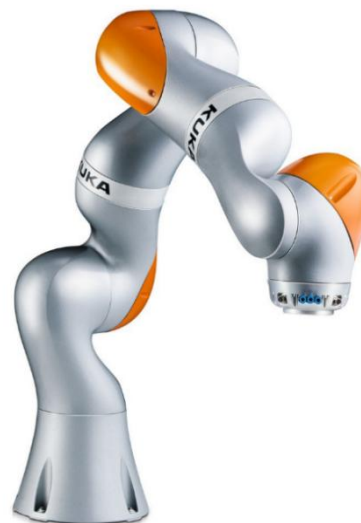
Figura 1 Robot KUKA LBR iiwa 14 R820 (Fuente: KUKA Robotics).
