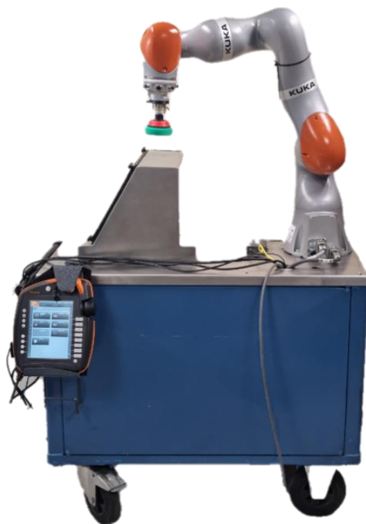
Figura 3 Plataforma experimental con el robot KUKA LBR iiwa 14
