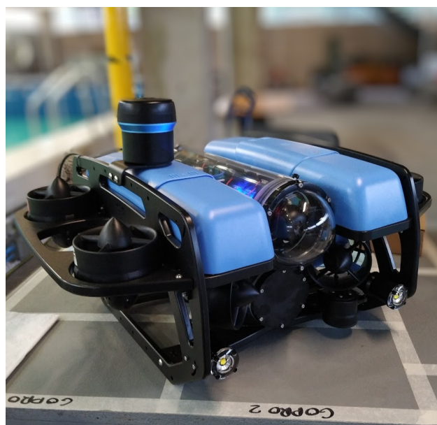
Figura 1: Imagen del BlueROV2 en su configuración pesada.
