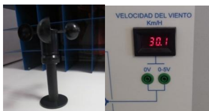
Figura 3: Anemómetro de copelas y display de velocidad del viento.
