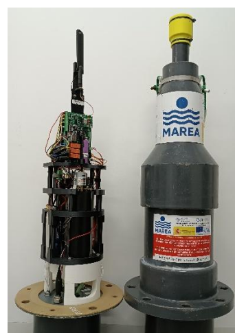
Figura 1. Estructura interna y externa del perfilador MAREA empleado en el estudio.
