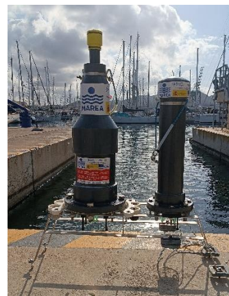
Figura 3. Integración final del sistema dual compuesto por el perfilador autónomo MAREA y el sistema automático de recolección de agua utilizado durante los ensayos experimentales.
