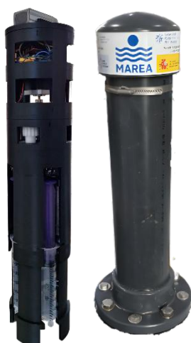
Figura 2. Estructura interna y externa del muestreador empleado en el estudio.
