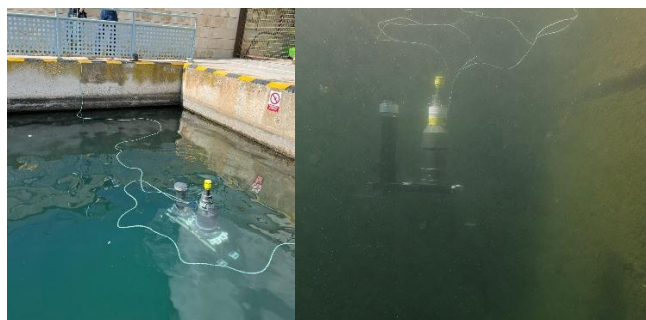
Figura 5. Entorno experimental utilizado para la realización de los ensayos de control de profundidad del sistema integrado en aguas portuarias.
