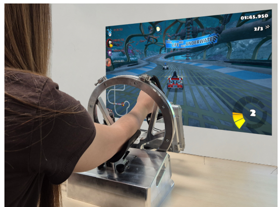
Figura 3: Participante interactuando con el videojuego SuperTuxKart mediante el robot de rehabilitación de muñeca M3Rob.
