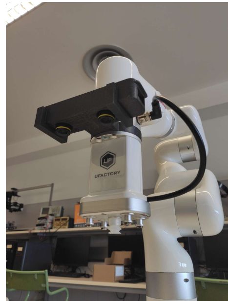
Figura 1: Configuración eye-in-hand del efector final con cámara ZED Mini y ventosa eléctrica.
