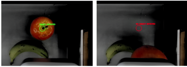
Figura 9: Sistema de verificación del agarre basado en ROI: la ausencia del objeto indica una captura correcta.
