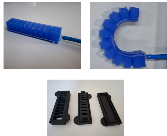
Figura 5: Primer prototipo funcional fabricado con EASYL-925-FDA junto con sus moldes.
