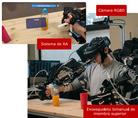
Figura 1: Sistema robótico bimanual de tipo exoesqueleto controlado mediante un sistema de RA. El sistema muestra una IU que se controla mediante un sistema integrado de seguimiento ocular.
