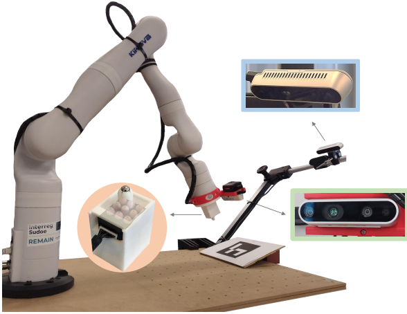
Figura 1: Plataforma robótica experimental sobre la que se ha implementado el controlador servo-visual híbrido para posicionamiento sobre un objeto
