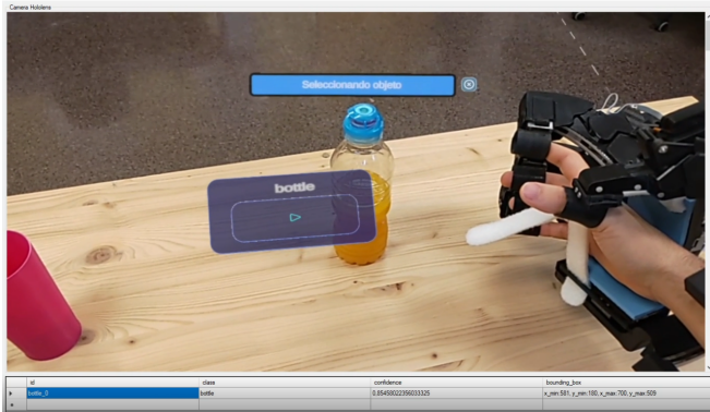
Figura 2: Visualización en RA durante el proceso de selección de un objeto interactivo y despliegue de información al usuario. Durante la selección, el color del texto del botón cambia a “cian”.
