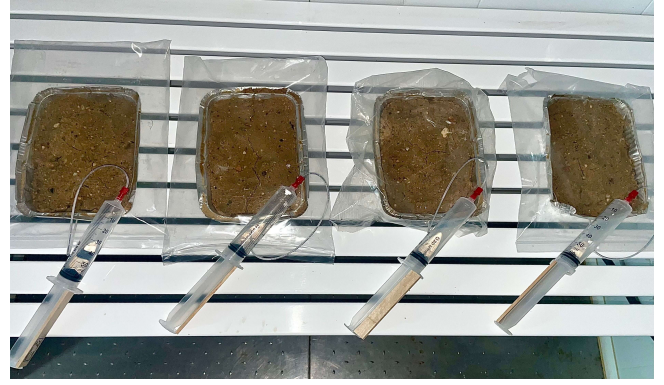
Figura 1: Muestras agronómicas. Suelo contenido en bandejas de aluminio con instalación de sondas Rhizon Soil Moisture Samplers.
