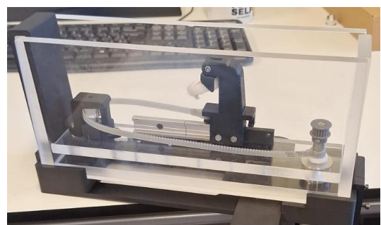
Figura 6: Rotura de la correa en la maqueta de prueba de la primera versión
