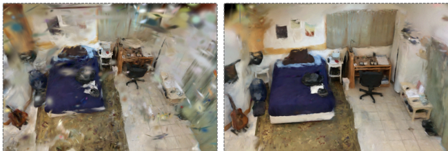
Figura 4: Comparación geométrica en la secuencia scene0000.01 de ScanNet. A la izquierda, imagen de la escena con inicialización aleatoria. A la derecha, imagen de la escena con las mejoras geométricas propuestas.
