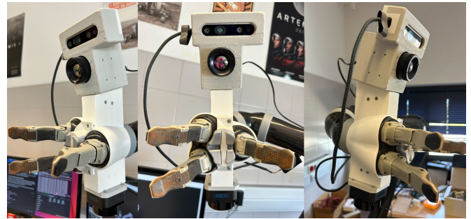
Figura 1: Integración de los sensores multimodales en el efector final del brazo Kinova Gen 2.
