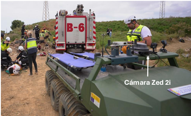
Figura 10: Robot J8 durante la intervención, con la ubicación de la cámara.
