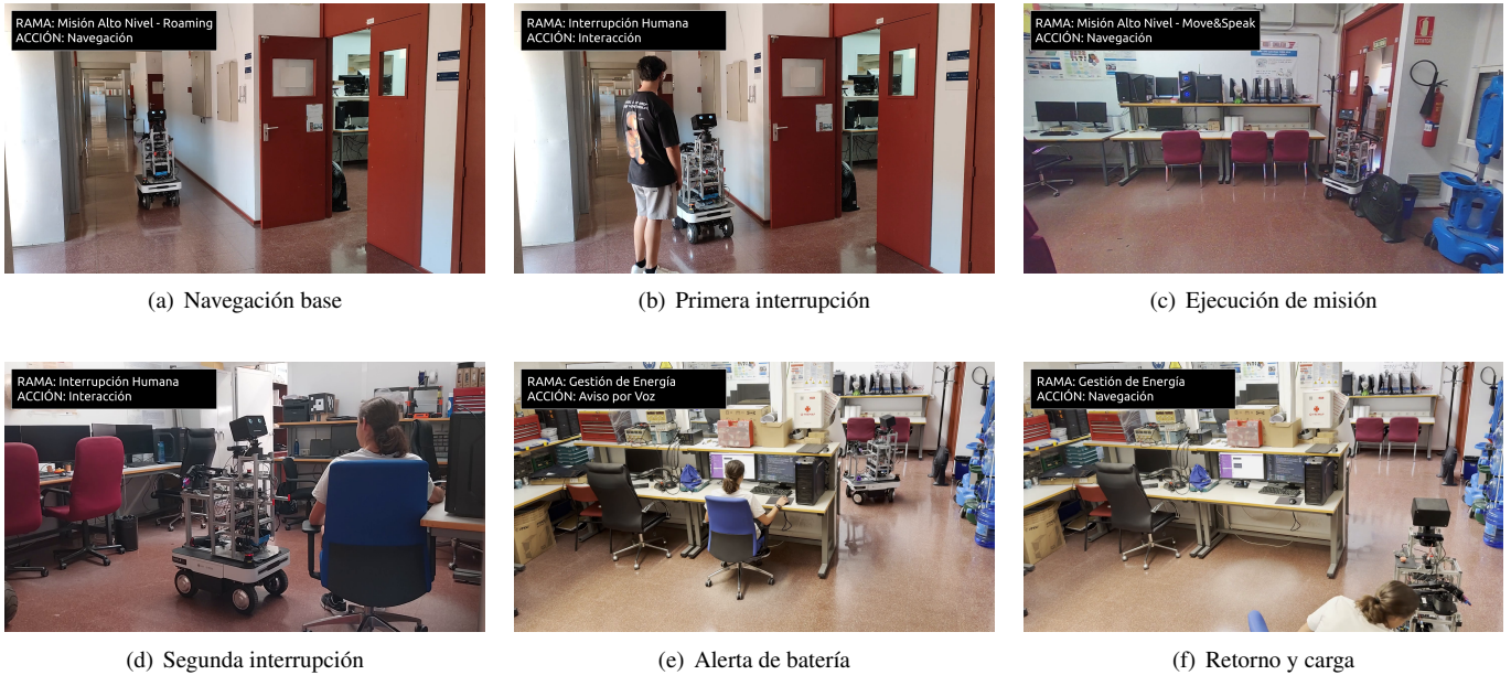
Figura 3: Secuencia de eventos del experimento global. (a) El robot opera en la misión base de roaming . (b) Un usuario interrumpe la navegación mediante el wakeword para asignar una tarea verbalmente. (c) El robot navega hacia el laboratorio indicado en la primera misión. (d) Tras completar la solicitud, un segundo usuario lo interpela y le asigna una nueva misión. (e) Durante este segundo trayecto, se inyecta una alerta de batería crítica, forzando la ejecución de la rama de gestión de energía. (f) El robot aborta la tarea en cuestión y se aproxima a su estación para la recarga asistida. En todos los fotogramas se incluye en la esquina superior izquierda el indicador del nodo activo en el Árbol de Comportamiento.
