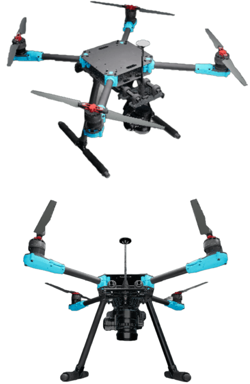
Figura 2: Modelo de agente: cuadricóptero X500 v2 con cámara/ gimbal Zenmuse X5S .
