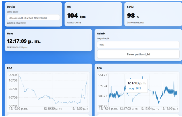
Figura 6: Dashboard web para identificación de dispositivo y visualización remota de HR, SpO 2 , EDA/GSR y ECG. La captura corresponde a una prueba funcional de laboratorio y no debe interpretarse como validación clínica.
