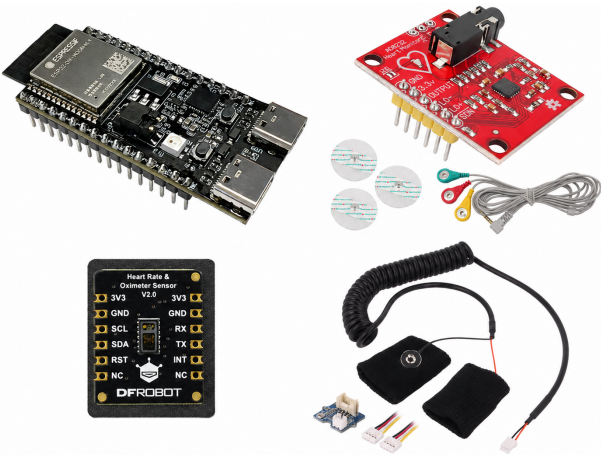
Figura 3: Módulos principales utilizados en el prototipo: placa ESP32-C6-DevKitC-1, módulo ECG AD8232, sensor óptico DFRobot Blood Oxygen para HR y SpO 2 , y sonda GSR/EDA.
