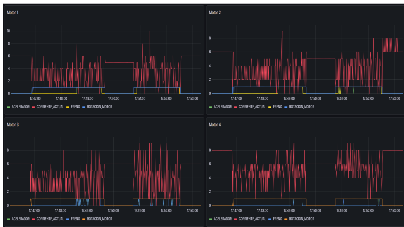
Figura 6: Visualización en Grafana de variables registradas durante un ensayo sobre los cuatro motores del FOX.
