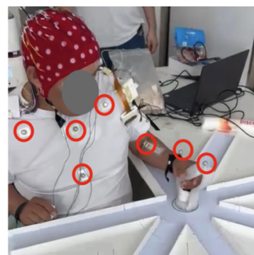
Figura 4: Configuración experimental y posicionamiento de marcadores. Sujeto instrumentado con gorro EEG de 64 canales, matrices de HD-sEMG distribuidas en siete músculos del miembro superior y marcadores infrarrojos para seguimiento cinemático tridimensional en la plataforma 2D.
