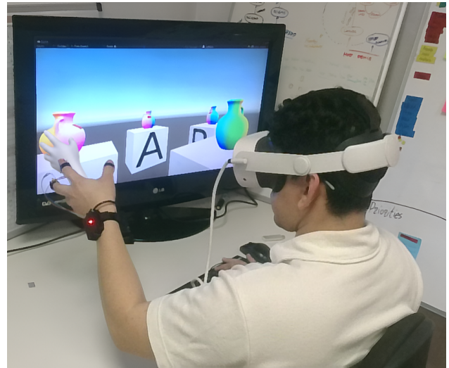
Figura 4: Ensayo de la realimentación vibrotáctil con el guante háptico.
