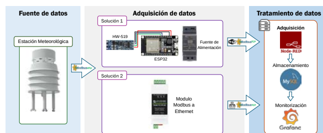
Figura 4: Monitorización IoT de la estación meteorológica
