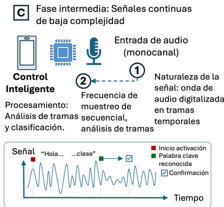
Figura 4: Control inteligente aplicado a señales continuas monocanal.
