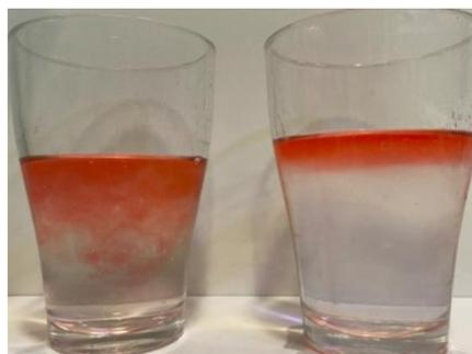
**Figura 2.** Experiencia para comprender las corrientes superficiales y de profundidad, diferenciando el comportamiento del hielo (con colorante) al fundirse en agua sin sal (izquierda) y agua salada (derecha). Fuente: elaboración propia
