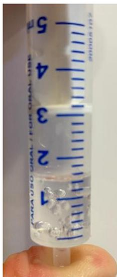
**Figura 5.** Experiencia para demostrar el efecto de la presión en los cambios de estado. Fuente: elaboración propia
