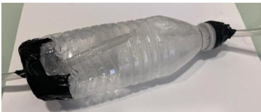
**Figura 6.** Condensador con materiales caseros para la experiencia en la que se separa agua de una mezcla mediante destilación. Fuente: elaboración propia
