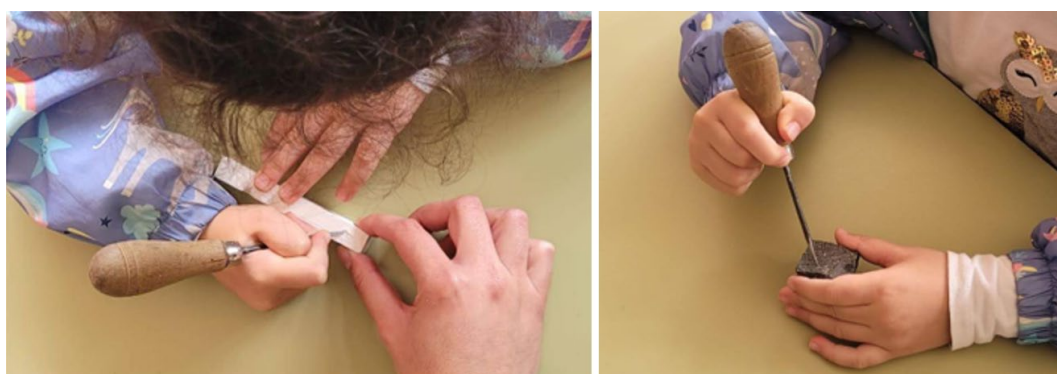
Figura 6. Prueba de la dureza en distintos materiales
