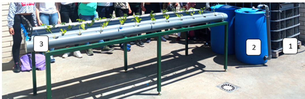
Figura 4. Equipo acuapónico. 1. Tanque de peces. 2. Biofiltro. 3. Sistema hidropónico
